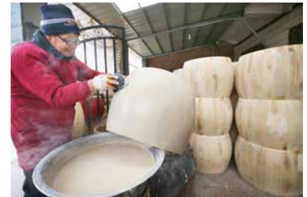
Der Trommelkörper wird glatt geschmirgelt und mit Talkpuder und Leim bestrichen, so lässt sich Farbe leichter auftragen und der Trommelkörper wird zusätzlich stabilisiert.
