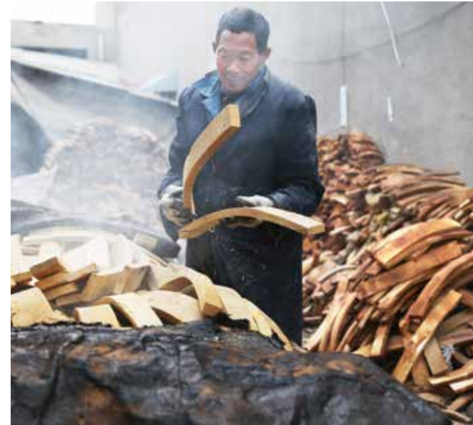
Das Holz des chinesischen Surenbaums und der Ulme ist am besten für den Bau der Trommeln geeignet. Um es vor Fäulnis zu schützen, wird es am Feuer getrocknet.
